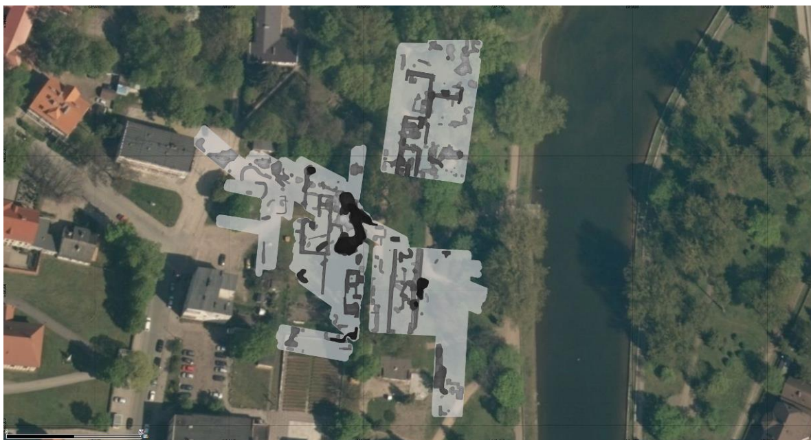
Ryc 278. Analityczne kartowanie anomalii radarowych z zaznaczeniem zasięgu badań nałożone na ortofotomapę. Im ciemniejszy kolor tym większa względna głębokość zalegania źródła anomalii.
