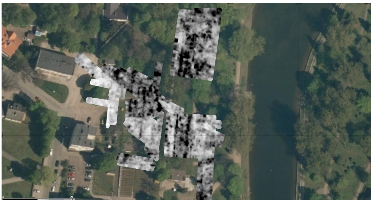
Ryc 257. Wizualizacja przetworzonych pomiarów radarowych do postaci planu na głębokości 18-27 ns/90-140 cm p.p.t. nałożona na ortofotomapę.
