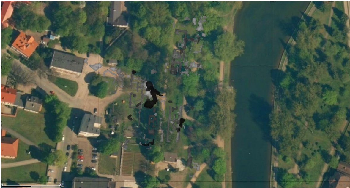
Ryc 279. Analityczne kartowanie anomalii radarowych nałożone na ortofotomapę. Im ciemniejszy kolor tym większa względna głębokość zalegania źródła anomalii.
