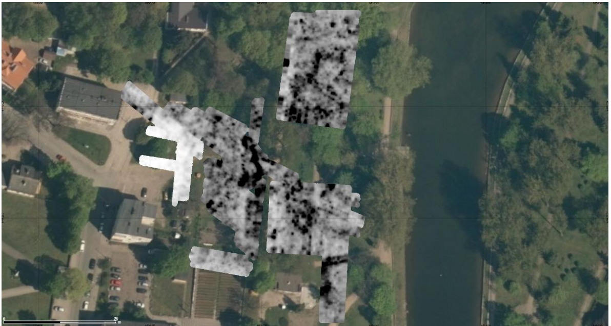
Ryc 264. Wizualizacja przetworzonych pomiarów radarowych do postaci planu na głębokości 45-54 ns/220-260 cm p.p.t. nałożona na ortofotomapę.
