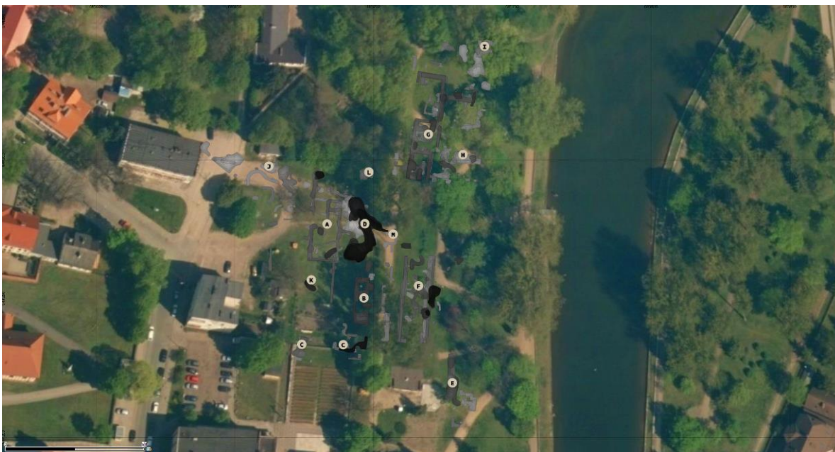
Ryc 280. Analityczne kartowanie anomalii radarowych z oznaczeniami nałożone na ortofotomapę. Im ciemniejszy kolor tym większa względna głębokość zalegania źródła anomalii.
