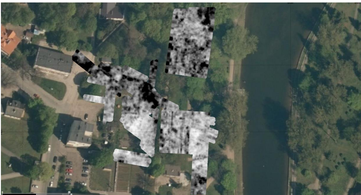
Ryc 253. Wizualizacja przetworzonych pomiarów radarowych do postaci planu na głębokości 4-12 ns/20-60 cm p.p.t. nałożona na ortofotomapę.
