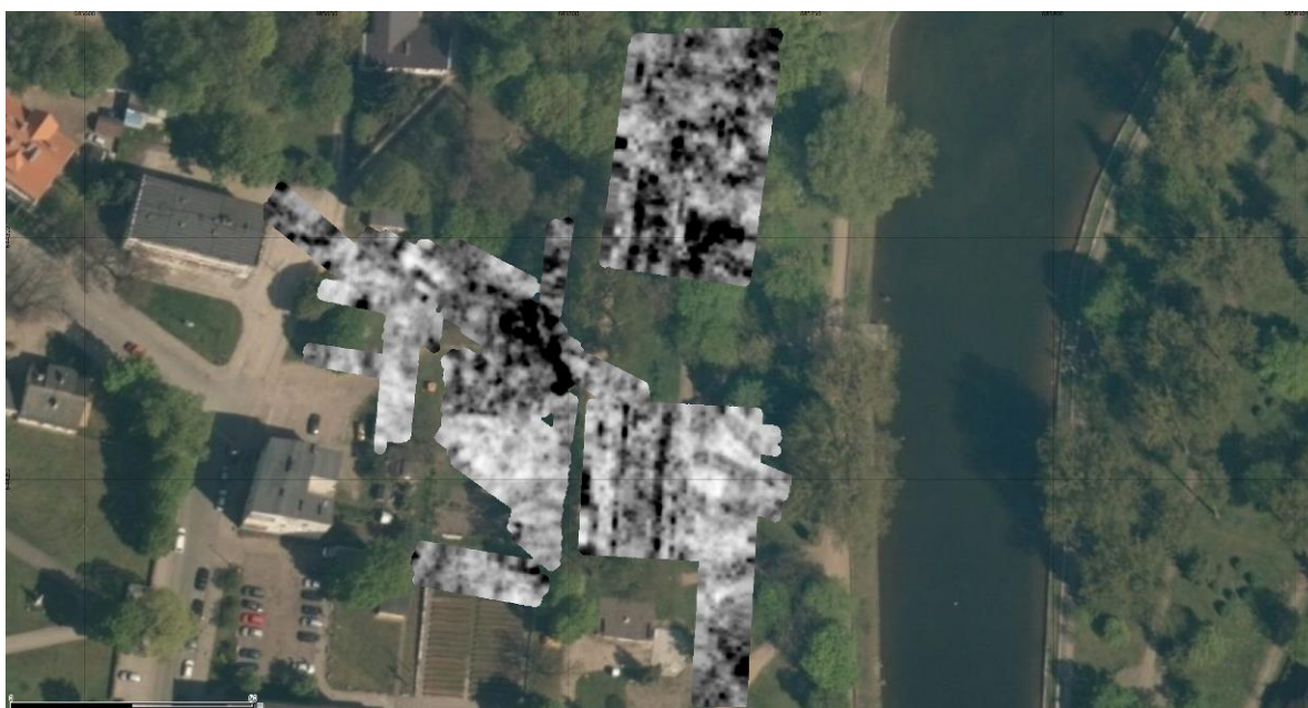
Ryc 255. Wizualizacja przetworzonych pomiarów radarowych do postaci planu na głębokości 11-20 ns/60-100 cm p.p.t. nałożona na ortofotomapę.
