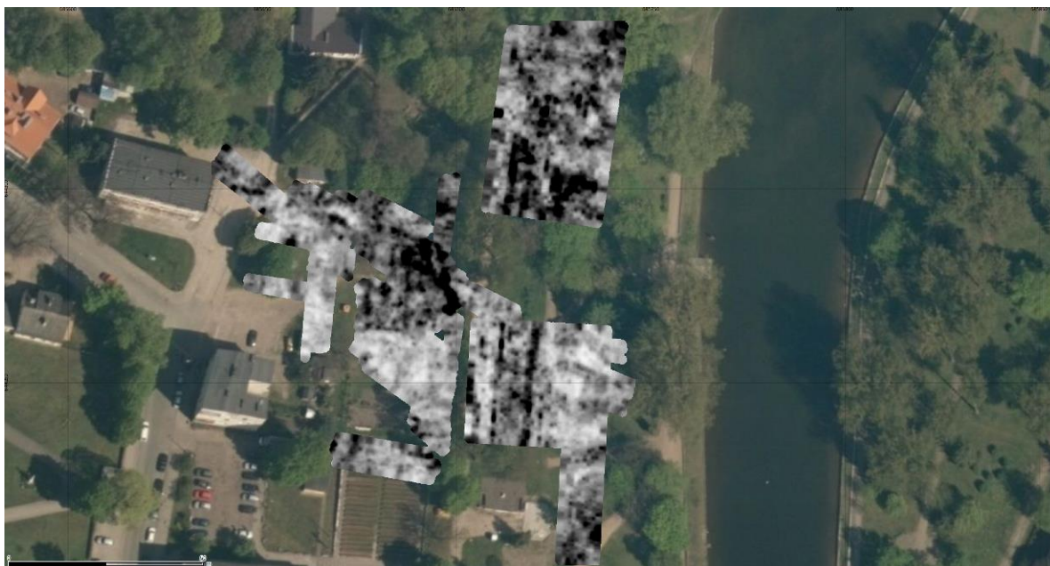
Ryc 256. Wizualizacja przetworzonych pomiarów radarowych do postaci planu na głębokości 15-23 ns/80-120 cm p.p.t. nałożona na ortofotomapę.
