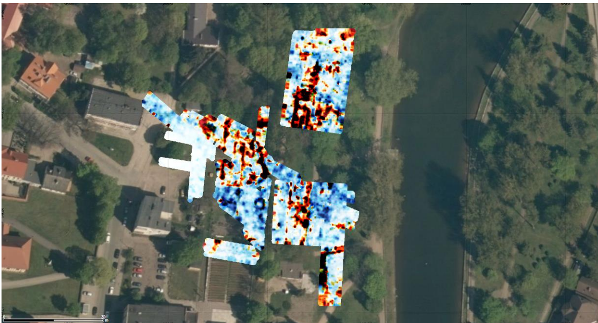
Ryc 252. Wielobarwny kompozyt wizualizacji przetworzonych pomiarów radarowych pokazujący anomalie na kilku głębokościach.
