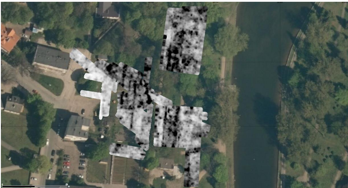
Ryc 258. Wizualizacja przetworzonych pomiarów radarowych do postaci planu na głębokości 22-31 ns/100-150 cm p.p.t. nałożona na ortofotomapę.
