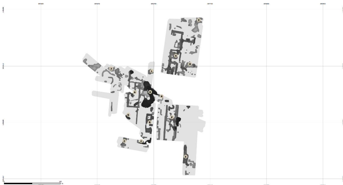
Ryc 277. Analityczne kartowanie anomalii radarowych z oznaczeniami i z zaznaczeniem zasięgu badań. Im ciemniejszy kolor tym większa względna głębokość zalegania źródła anomalii.
