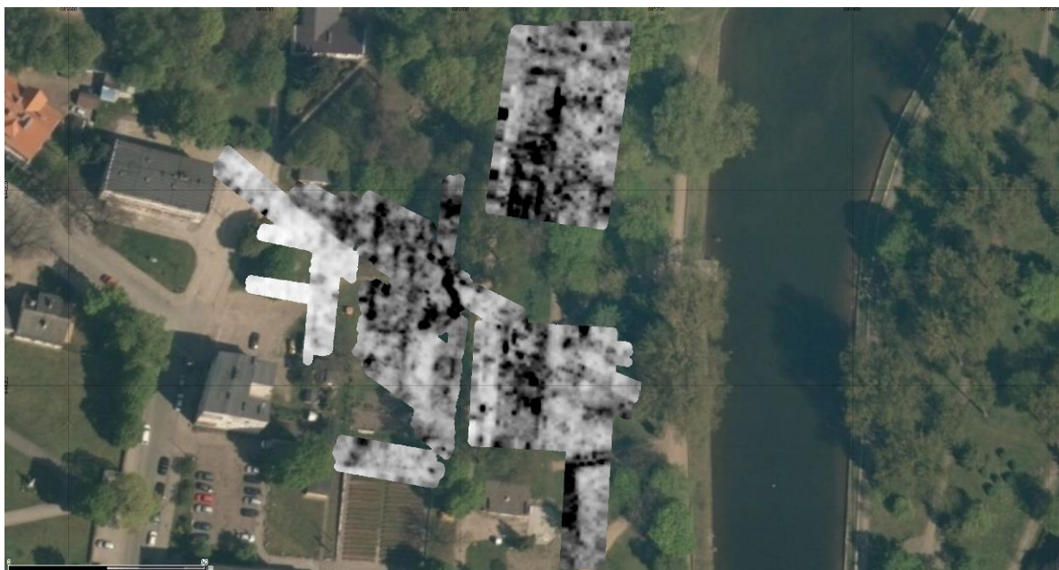
Ryc 260. Wizualizacja przetworzonych pomiarów radarowych do postaci planu na głębokości 30-38 ns/140-190 cm p.p.t. nałożona na ortofotomapę.
