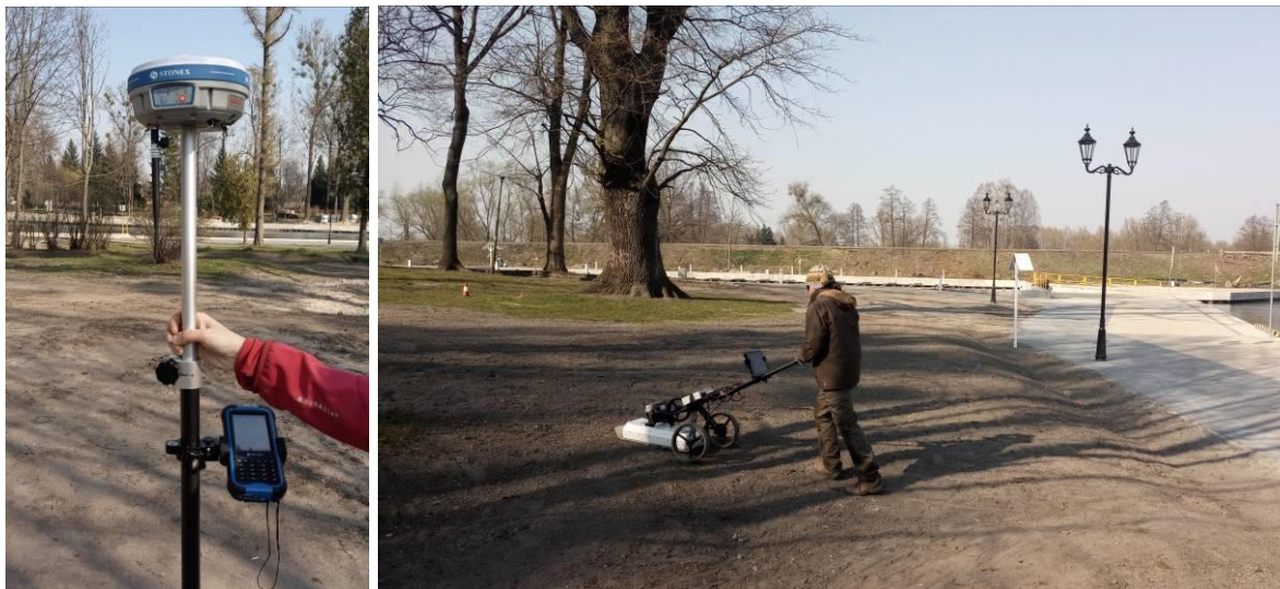
Ryc 3. Po lewej: urządzenie GPS RTK używane do pomiarów geodezyjnych. Po prawej: system georadarowy w użyciu.
