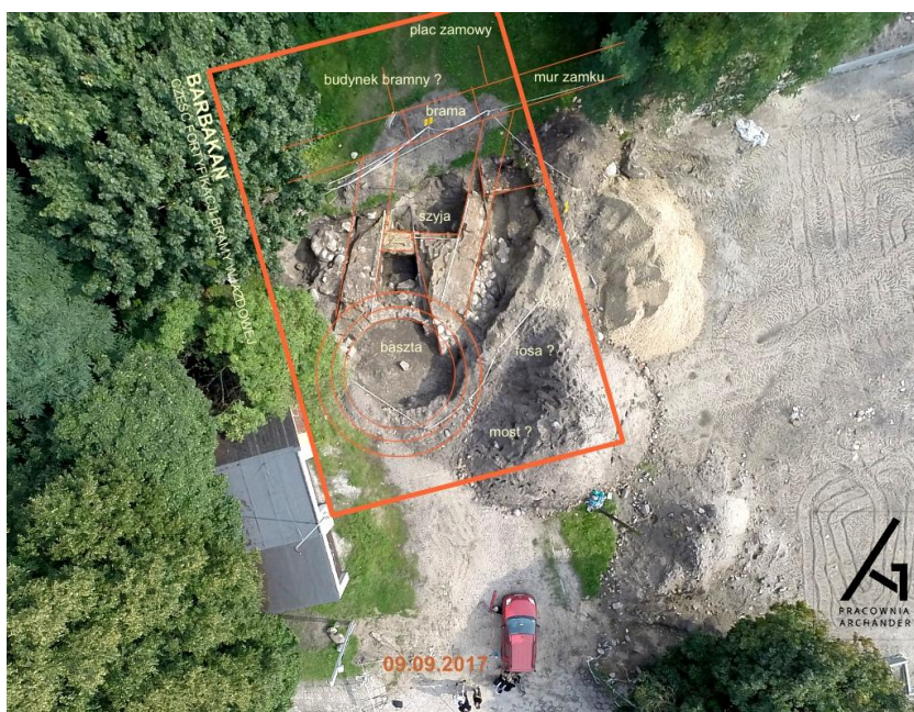
Fot. Wykop w trakcie badań Izabeli Mellin-Wyczółkowskiej z nakładką rysunkową opisującą formę fundamentów przed bramą wjazdową.
