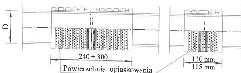
PRZEJŚCIA SZCZELNE TULEJOWE RÓWNOLEGŁE - PRZELOTOWE
